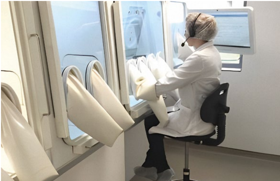
L'unité de production de Revatis utilise des technologies innovantes, comme la production en isolateur aseptique, pour limiter l'impact environnemental © RevaTis SA
